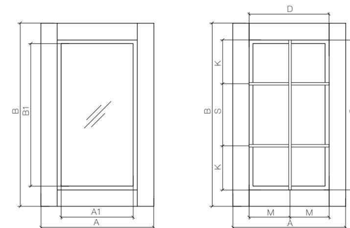
Расчет размера стекла для фасада «Ст»: A1=A-132 мм, B1=B-132 мм
